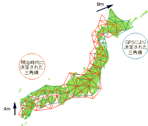
図 6-1 日本測地系と世界測地系の測地基準点成果の差
