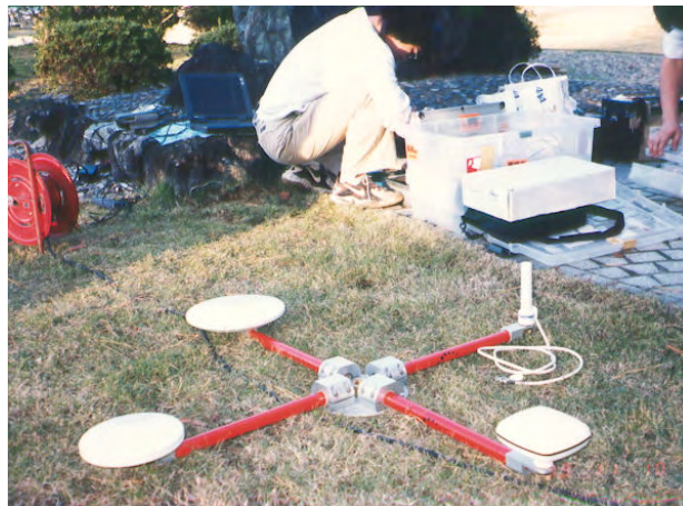
図 2-8 アンテナ設置用ステー
